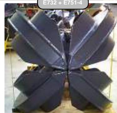
**Mehrschalengreifer mit 5 Greiferzylindern und Drehdurchführung
