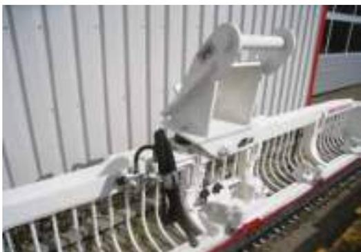
Die Aufnahmen (Korbträger) sind passend für das jeweilige Baggermodell oder die ggf. vorhandene Schnellwechseleinrichtung lieferbar. Auch Sonderabmessungen erhältlich. Unter zur Verfügungstellung der Kinematikdaten Ihres Baggers legen wir den optimalen Öffnungswinkel für den Mähkorb aus.
