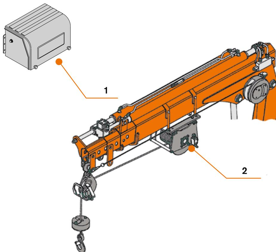
Optional kann der Kran mit einer Seilwinde (2), mit 500 kg Hubkraft, ausgestattet werden.
