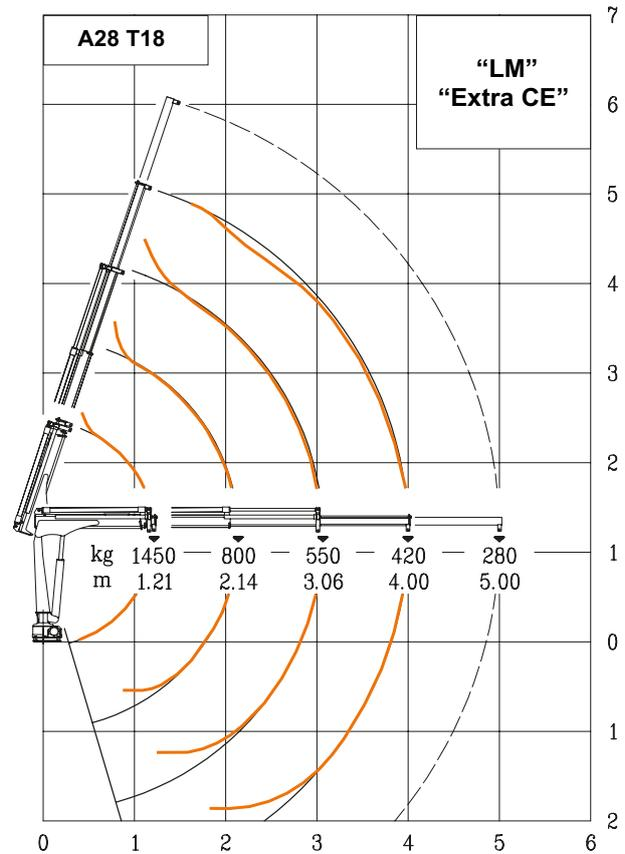
Auf der Version "LM" werden die mechanische Verlängerungen von der Überlastabschaltung nicht überwacht
